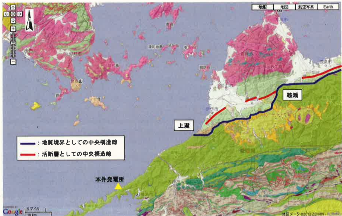
図 4 8 四国西部における地質境界としての中央構造線と 活断層としての中央構造線の対比
