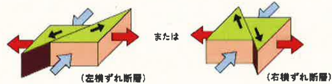
図27 断層運動の基本的なパターン
