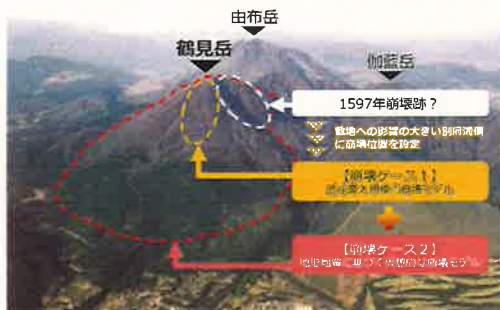
【崩壊ケース2】 地形地質に基づく仮想的な崩壊モデル
