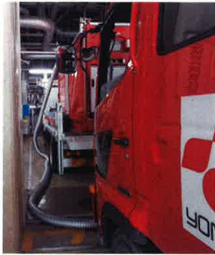
写真奥側: 中型ポンプ車 写真前側: 加圧ポンプ車
