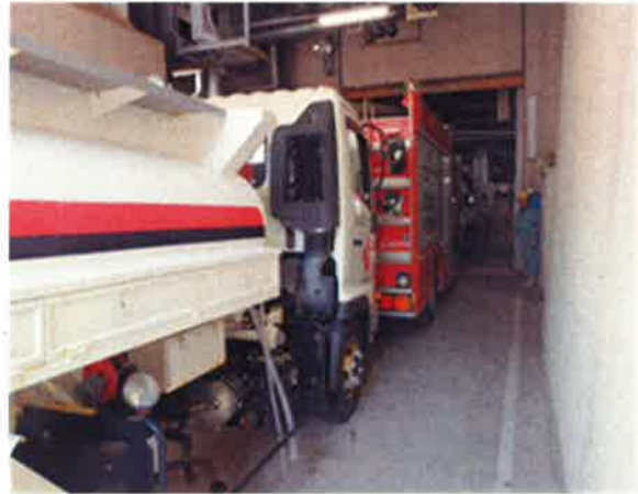
写真奥側: 加圧ポンプ車 写真前側: ミニローリ(24時間にわたる活動に必要な燃料を積載)
